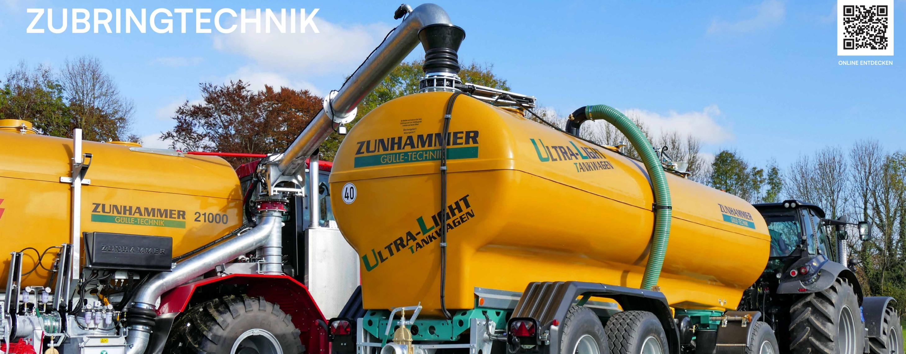
Viele Güllewagen dürfen voll beladen nicht legal am Straßenverkehr teilnehmen. Um keine Schlagkraft auf dem Acker zu verlieren, werden Zubringfässer eingesetzt. Die Zunhammer Zubringer zeichnen sich durch die hohe Nutzlast bei geringem Eigengewicht aus und versorgen die Ausbringfässer und Selbstfahrer auf den landwirtschaftlichen Flächen über Verkehrswege mit Gülle.
