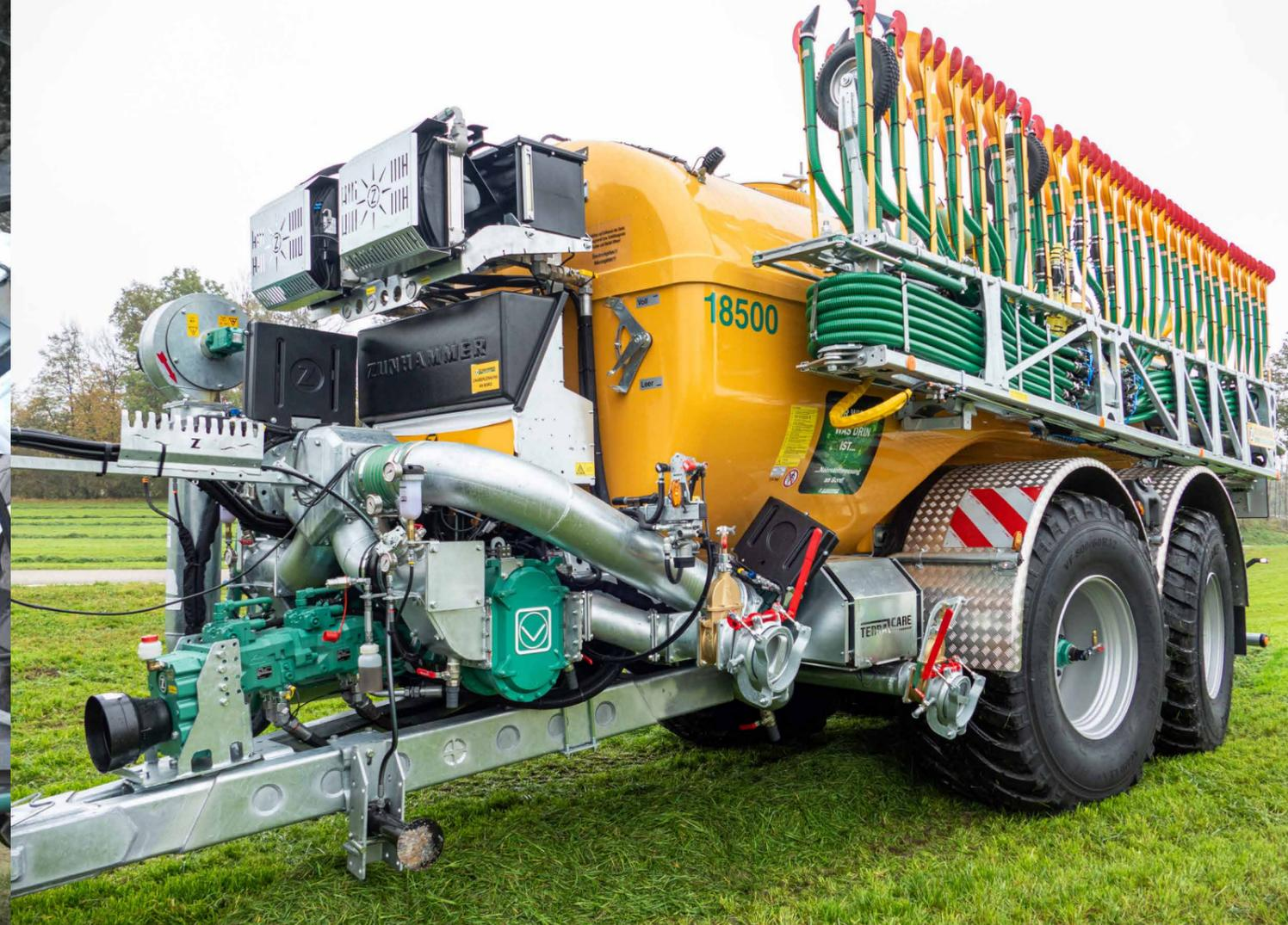
Von Zunhammer wurde mit LENA die elektrisch angesteuerte Zwangslenkung weiter verbessert. Der bisher verbaute „Patenthebel“ entfällt komplett. Das erleichtert und beschleunigt das Ankoppeln enorm, da lediglich die K80 Kugel, die elektrische Beleuchtung und das hydraulische Load-Sensing-System zu verbinden sind. Verbindungsgestänge können nicht mehr beschädigt werden.
