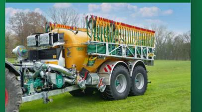
Entwicklung LENA-TWIN zwei Achsen werden elektrisch zwangsgelenkt.
