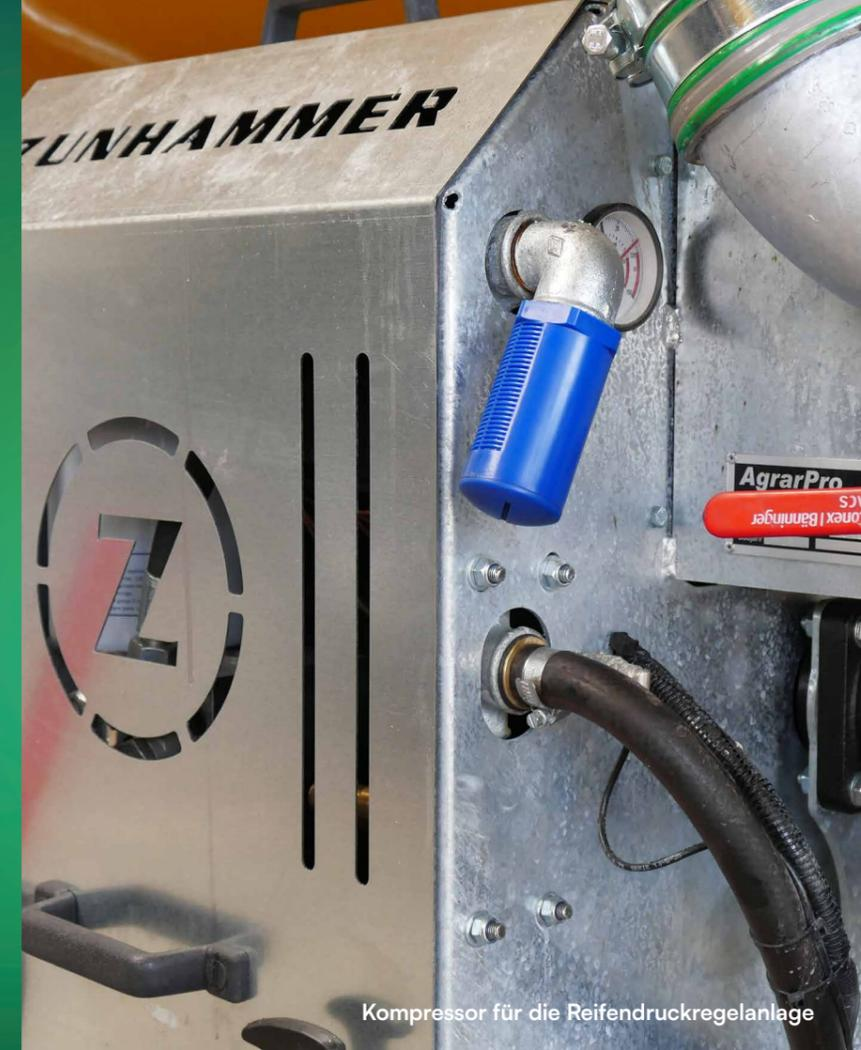
Kompressor für die Reifendruckregelanlage
